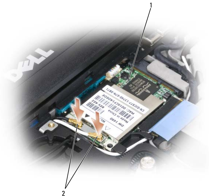
1 WLAN kartica 2 priključci antenskih kabela
